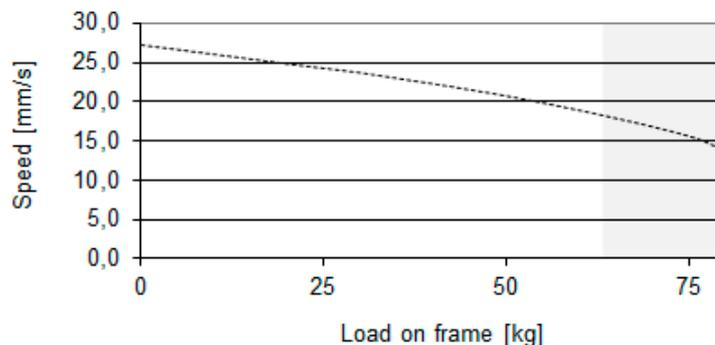
Die oben angezeigte Kurve bezieht sich auf eine mittig platzierte Last und ist nur gültig in Bezug auf die Einschaltdauer: 10% bei 50% der maximalen Nutzlast oder maximal 2 Minuten ohne Unterbrechung. Die oben angegebenen Daten können je nach Raumtemperatur, Luftfeuchtigkeit und Anschlußspannung variieren.
